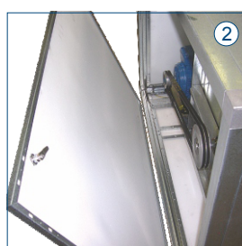
2 Niski poziom hałasu izolacja z melaminy
