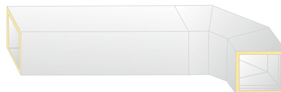
połącz elementy za pomocą kleju i taśmy aluminiowej
